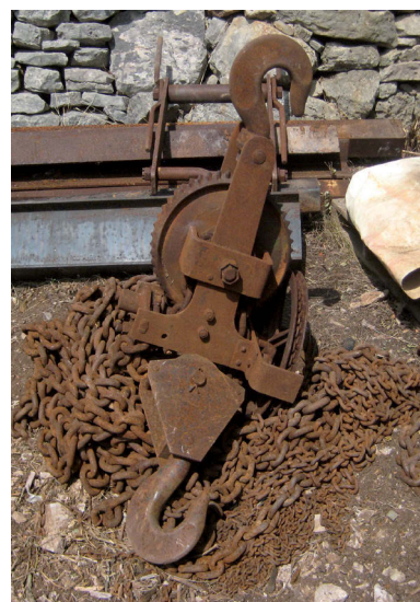
Εικ. 60: Η μηχανή ανύψωσης φορτίων που χρησιμοποιήθηκε στις στερεωτικές εργασίες του 1965 και 1966, στον αρχαιολογικό χώρο των Βασσών το 2012.
